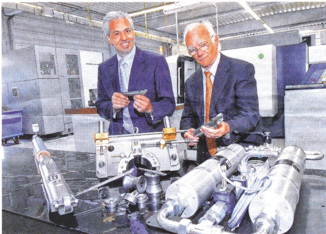
Arnd (l.) und Ernst **Blissenbach** zeigen das vom Seniorchef entwickelte **System**, mit dem Rohre von innen entgratet werden können. Die Oberfläche wird dadurch eben, außerdem sind Rohre so leichter zu verbiegen. BM-FOTO: NICO HERTGEN
